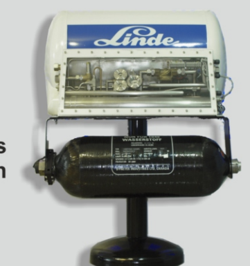
WASSERSTOFF: Niedrig-Temperatur- und Hochdruck-Tanksystem
