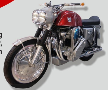
MÜNCH MAMMUT: Motorrad mit NSU-Automobilmotor
